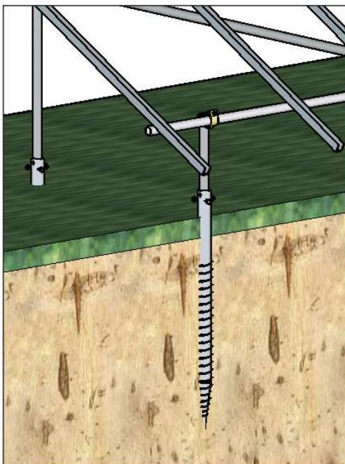
Le fondazioni a vite “neutre” possono essere installate manualmente o con l'impiego di avvitatore elettrico dinamometrico oppure con miniescavatore dotato di trivella.
