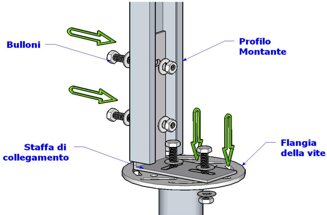
Segue l'installazione della struttura con profili pressopiegati
