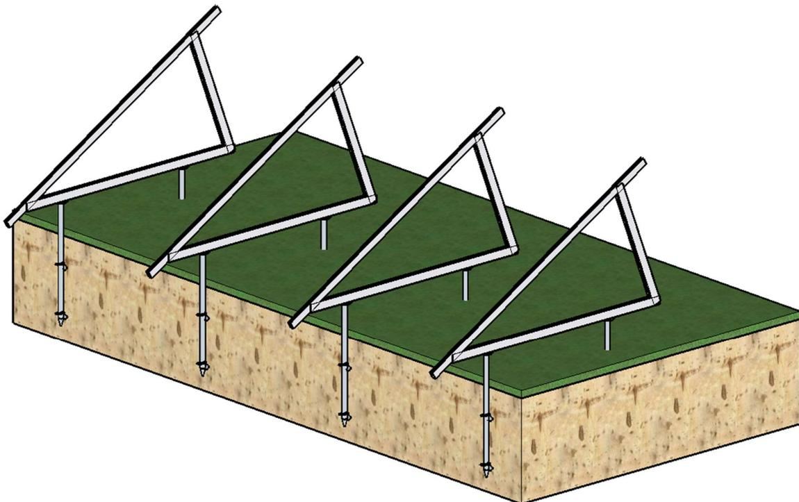
Sui traversi dei triangoli si fissano i profili correnti che ospiteranno i pannelli fotovoltaici
