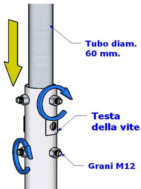
Definite le quote dei montanti verticali, sulla sommità dei pali si vanno a installare i supporti basculanti e i profili correnti della struttura.
